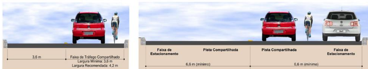
Figura 27: Concepção típica de vias com faixas de tráfego compartilhado. Na esquerda, sem faixa de estacionamento, na direita, com faixa de estacionamento
